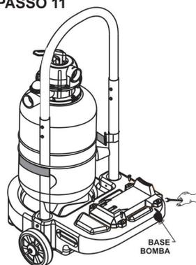
Fixar a base da bomba utilizando os parafusos (10). (**Chave de boca 10mm**).
