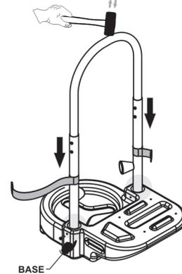
Encaixar o conjunto tubular na base plástica (03). Utilizar um martelo de borracha e bater suavemente até o tubo ficar bem encaixado, proteja o tubo com um pano para não danificá-lo ou sujá-lo.
