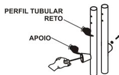
Fixar os apoios de borracha (5) nos perfis tubulares retos (1). Utilizar parafusos (8) e arruelas (7). (**Chave philips**).
