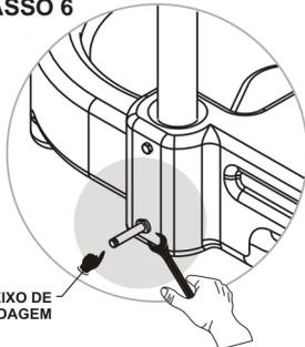
Fixar o eixo de rodagem (9) na base plástica (03). (**Chave de boca 16mm**).
