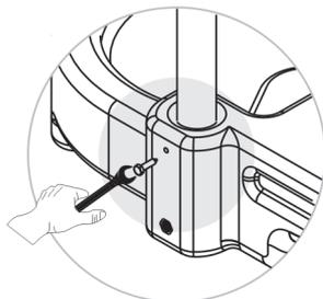
Fixar o conjunto tubular na base plástica (03) utilizando os parafusos (10). (**Chave de boca 10mm**).
