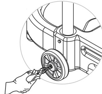
Travar a roda no pino de rodagem através do anel elástico (14). (**Alicate**).
