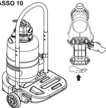
Posicionar o filtro e travá-lo com alça de travamento. Em seguida, retire a base da bomba.
