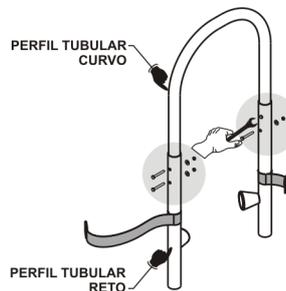
Encaixar e fixar o perfil tubular curvo (2) nos perfis tubulares retos (1). Utilizar parafusos (11), porcas (12) e arruelas (13). Chave de boca 10mm.
